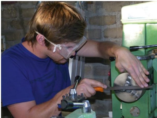
Abb. 3 – Die Inneren Planeten werden von Thomas Roßwog aus Schraubenköpfen gedreht
